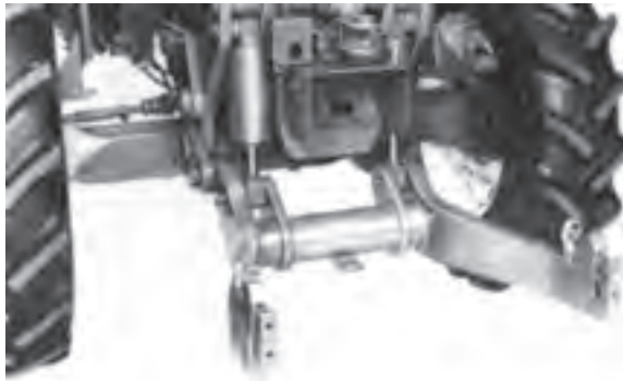
شکل ۲-۳- اتصال سه نقطه جلو (در تراکتور JD ۳۳۵۰)
