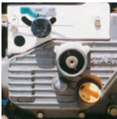
شکل ۹-۱۴- اهرم گاز در حالت استارت
