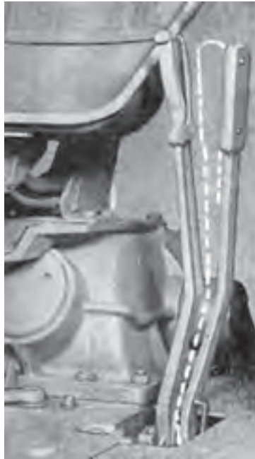
شکل ۷-۲- اهرم دیفرانسیل جلو (در تراکتور M ۶۵۰ U)
