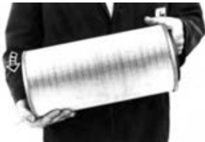
شکل ۱۱-۴- تمیز کردن استوانه صافی با ضربه
