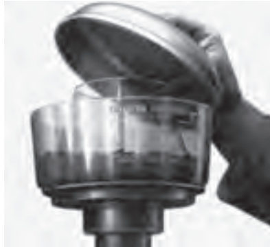
شکل ۲-۴- پیش صافی و تمیز کردن آن
