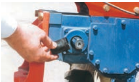
شکل ۳-۹- محور انتقال نیرو و درپوش روی آن
