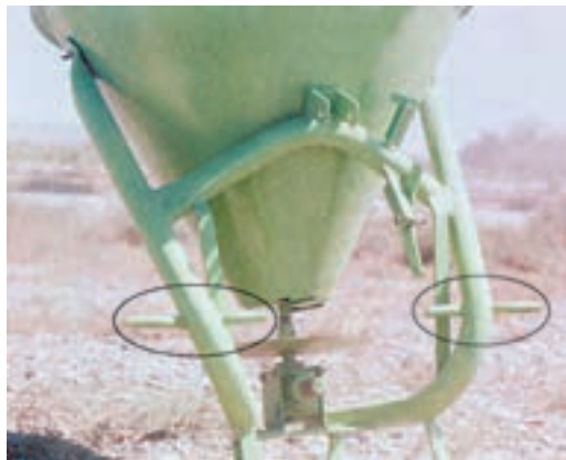
شکل ۱۸-۳- بذریاش قابل اتصال به دو گروه از تراکتورها
