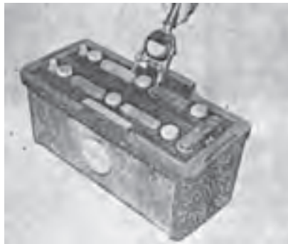
شکل ۴۶-۴ آزمایش ولتاژ یک خانه باتری
