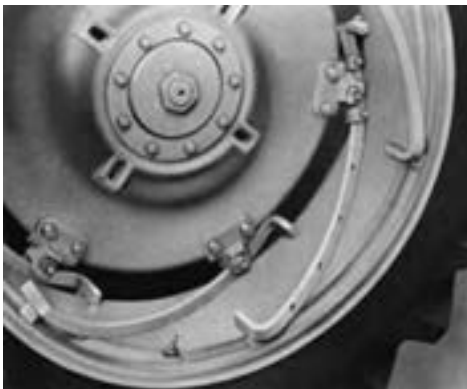
شکل ۱۳ - ۸ - اتصال دیسک به رینگ روی ریل
