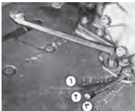
وضعیت (۱) موتور گرد، وضعیت (۲) خلاص، وضعیت (۳) چرخ گرد شکل ۲-۷- اهرم محور انتقال نیرو در تراکتور U 650 M
